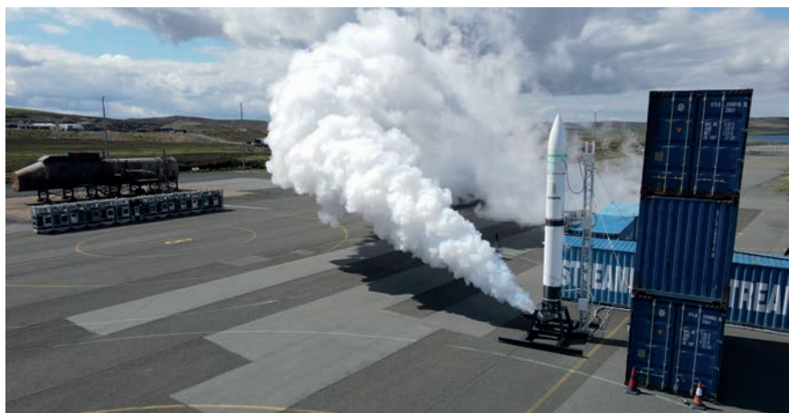
Испытания РН СЛК с гибридным двигателем
